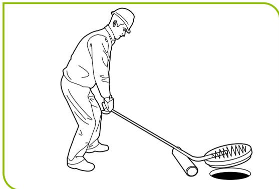
Figura 27, Levanta y mueve tapas de alcantarillas.
